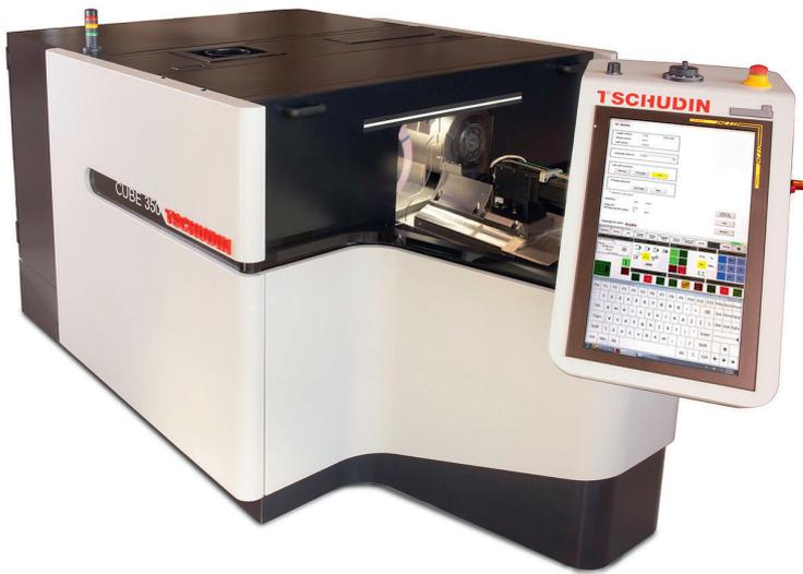
1 Die Spitzenlos-Schleifmaschine Tschudin Cube 350, die für Como Industries produziert wurde und dort die Produktivität bis zu verfünffachte
